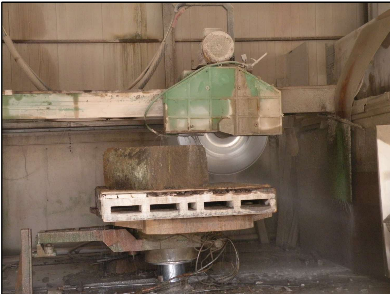
Figura 19: Esempio di sega a bandiera usata nel settore estrattivo della PAT
